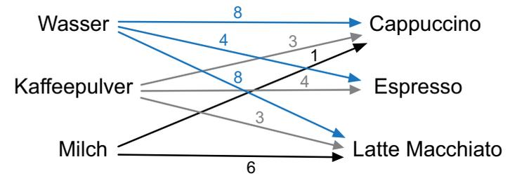
Um auf die benötigten Zutaten zu kommen, multipliziert man die Übergangsmatrix mit dem Bedarfsvektor und erhält:  $\vec{y} = \begin{pmatrix} 8 & 4 & 8 \\ 3 & 4 & 3 \\ 1 & 0 & 6 \end{pmatrix} \cdot \begin{pmatrix} 6 \\ 4 \\ 12 \end{pmatrix} = \begin{pmatrix} 160 \\ 70 \\ 78 \end{pmatrix}$
