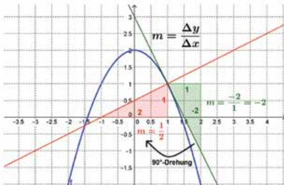
Eine Normale steht orthogonal, also im rechten Winkel, zur Tangente. Dies entspricht einer 90°-Drehung. Zeichnet man ein Steigungsdreieck ein, erkennt man, dass sich auch diese um 90° mitdreht, wodurch die Zuordnung von  $\Delta y$  und  $\Delta x$  getauscht werden. Es liegt daher der Kehrwert der Steigung vor. Aufgrund der Richtungsänderung (von Fallen nach Steigen) ändert sich gleichzeitig das Vorzeichen der Steigung.
