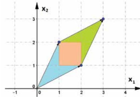
Jede Farbe im Parallelogramm steht für 1 FE, sodass man gut erkennen kann, dass der Flächeninhalt dem Betrag der Determinante entspricht. Die Spaltenvektoren von A spannen das Parallelogramm auf.
