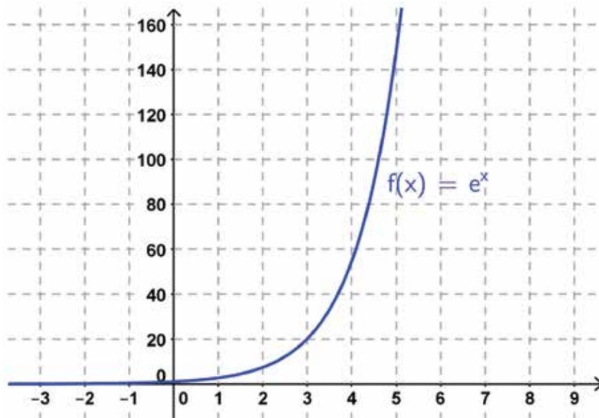
Die e-Funktion ist streng monoton steigend. Sie besitzt weder Nullstellen noch Extremstellen. Alle Werte der e-Funktion sind positiv.
