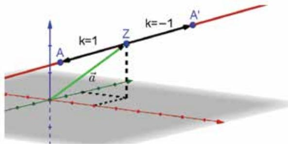
Soll ein Punkt A an einem Punkt Z im Raum gespiegelt werden, so kann dies mit Hilfe einer Parameterdarstellung der Geraden durchgeführt werden.
