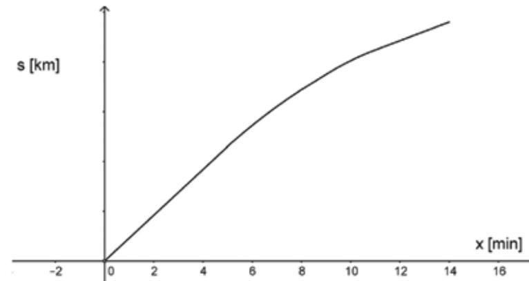
In den Abschnitten in denen ein konstanter Wert vorliegt, muss eine lineare Funktion entstehen. Aus den Geraden wird eine Parabelform mit Rechtskrümmung.
