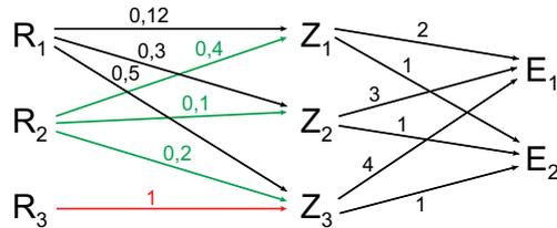
Die Rohstoff-Endprodukt-Matrix erhält man, indem man die Rohstoff-Zwischenprodukt-Matrix mit der Zwischenprodukt-Endprodukt-Matrix multipliziert:
