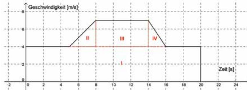
$$A_I = 20 \text{ s} \cdot 4 \text{ m/s} = 80 \text{ m} \quad A_{II} = \frac{1}{2} \cdot 3 \text{ s} \cdot 3 \text{ m/s} = 4,5 \text{ m}$$
